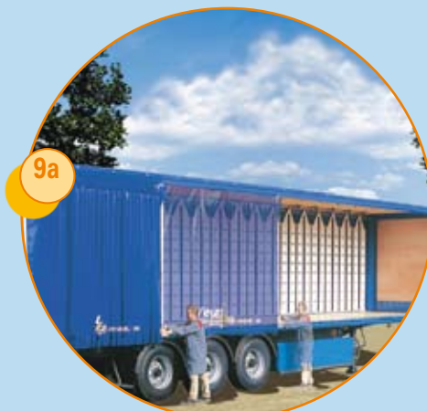
Ouverture latérale totale d'une semi-remorque à partir du sol
