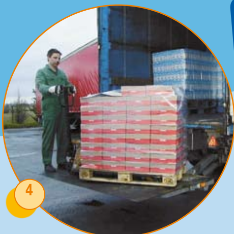
Véhicule équipé d'un hayon élévateur et d'un transpalette embarqué
