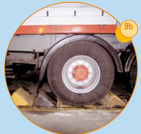
Dispositif de calage d'une roue du camion asservi au quai de transbordement
