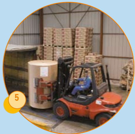
Utilisation d'un chariot automateur à conducteur porté pour décharger des bobines de papier
