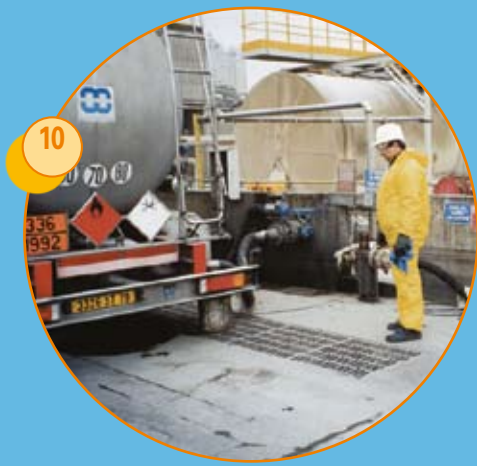
Opération de dépotage d'un véhicule citerne de produit chimique
