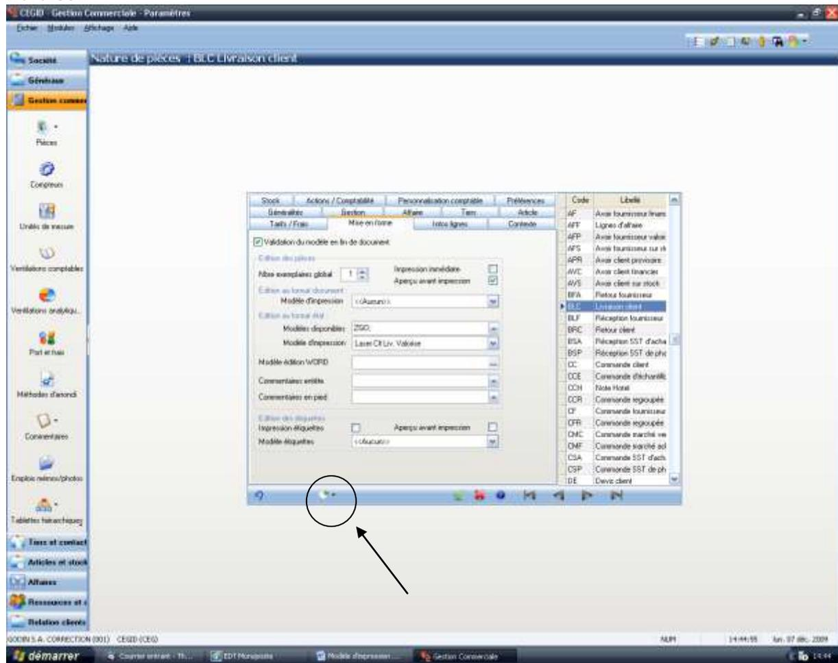
Sur l'onglet Mise en forme, cocher « aperçu avant impression » ce qui permettra de voir le document avant qu'il ne soit lancé à l'impression.
